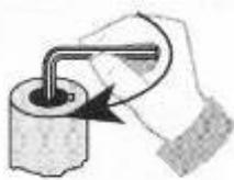
Régler la durée de distribution (en mois) sur la tête de commande à l'aide d'une clé à imbus (SW3). Lire la quantité de graisse désirée sur le diagramme en page 7.
